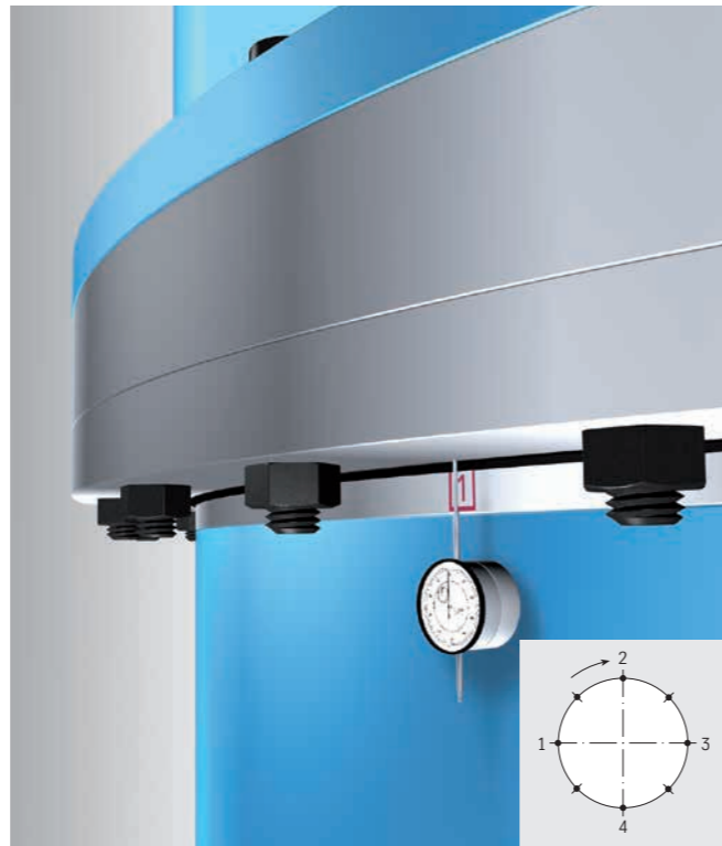
Figura 6: Configuração básica de medição da folga de inclinação
