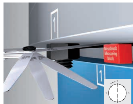
9. kép: A résmérővel végrehajtott süllyedésmérés elvi felépítése
