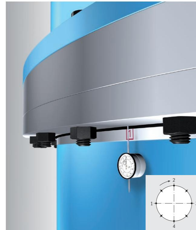
图 6: 倾斜间隙测量的原理构建
