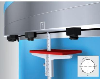
图 8: 利用游标深度卡尺进行下沉测量的原理构建
