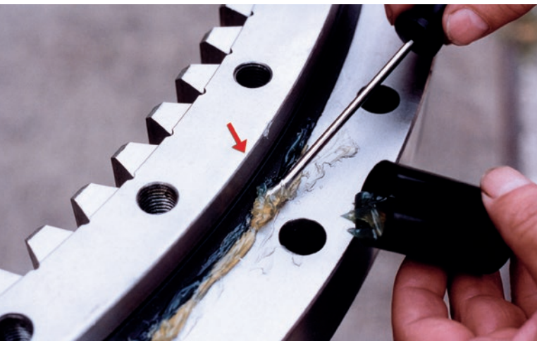
Afbeelding 17: Ontnemen van het vet aan de afdichtingslip
