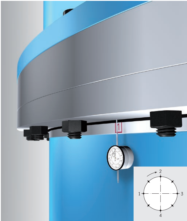
Afbeelding 6: Principiële opbouw van de kantelspelingmeting
