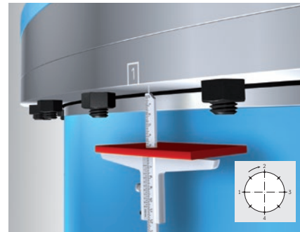
Afbeelding 8: Principiële opbouw van de dalingsmeting met diepteschuifmaat
