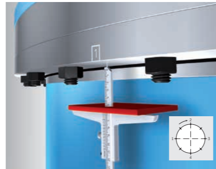
Figura 8: Struttura base per la misurazione del cedimento assiale tramite calibro di profondità
