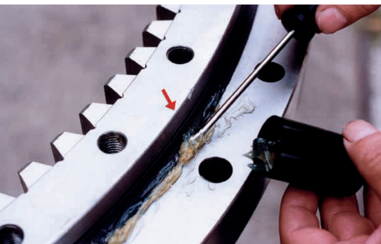
Afbeelding 17: Ontnemen van het vet aan de afdichtingslip
