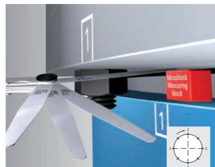
Bild 9: Principiell uppbyggnad av nedsänkingsmätningen med bladmått
