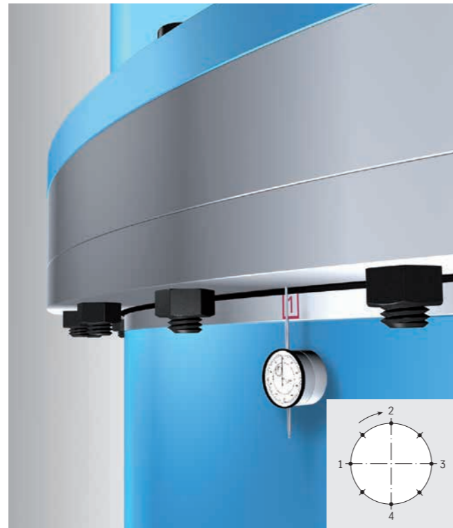
Figura 6: Estructura básica de la medición de la holgura de vuelco
