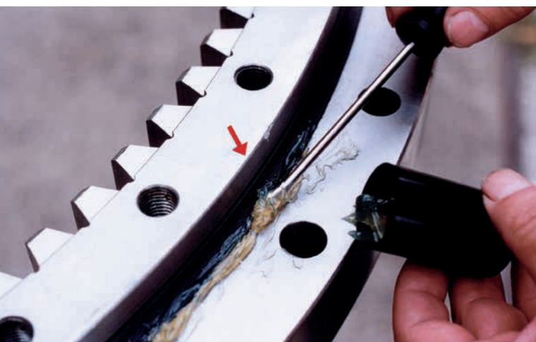
Figura 17: Toma de grasa en la falda de obturación
