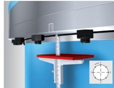
Bild 8: Prinzipieller Aufbau der Absenkmessung mit Tiefenmessschieber
