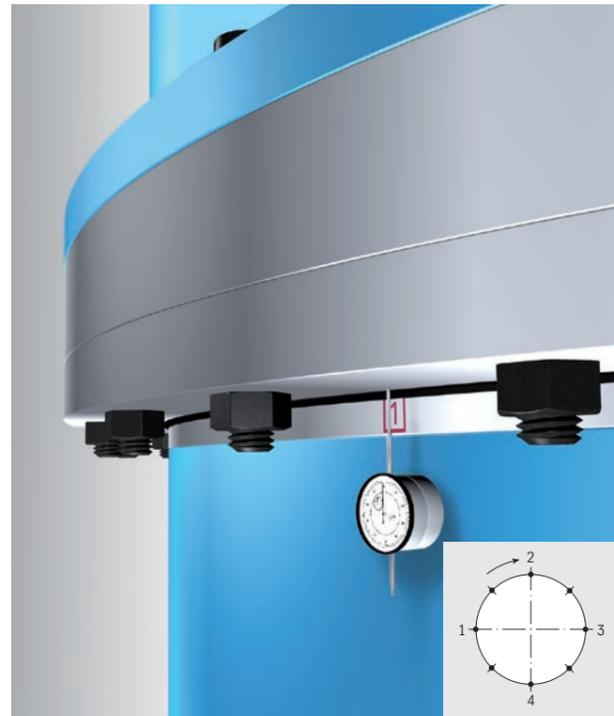
Bild 6: Prinzipieller Aufbau der Kippspielmessung
