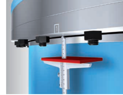
صورة 8: التركيب الأساسي لقياس الانخفاض باستخدام مقياس العمق
