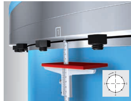
図8: デプスゲージによるアキシャル寸法測定方法
