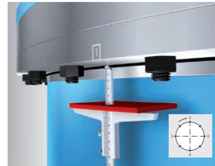
Илл. 8: Принцип измерения осевого перемещения с помощью штангенглубиномера
