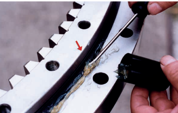
Figure 17: Prélèvement de graisse au niveau de la lèvre du joint
