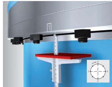
Figure 8: Principe structurel de la mesure d'affaissement avec un pied à coulisse de profondeur
