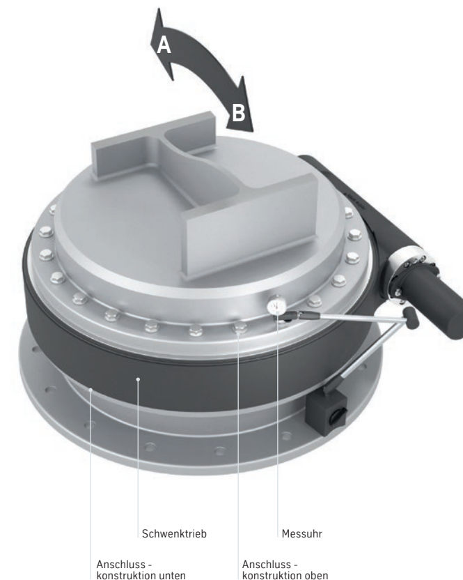
Abbildung 4: Prinzipieller Aufbau der Kippspielmessung
